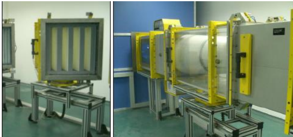
图 4 测试管道中的被测过滤器样品
