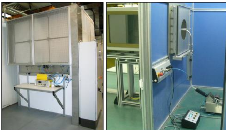
图 3 带进气口过滤器的混合室和气溶胶发生器（粉尘和雾化）；右图为内部视图
